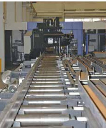
Die Abfuhrrollenbahn hinter der Behringer Gehrungsbandsäge HBP410-723G. Zur Rechten die Parktaschen für die fertig bearbeiteten Werkstücke
